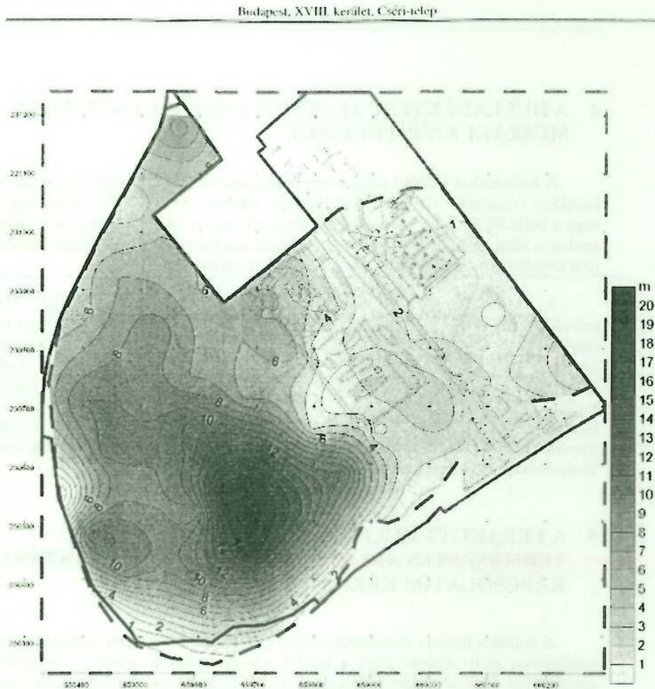
5. ábra. Budapest XVIII. ker. Cséri-telep. A feltöltés-vastagság izovonalas térképe és az ingatlan területén található épületek és építmények
